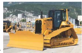
大型ブルドーザー「D6N」 (全長:約6m×横幅:約4m×高さ約3.8m)
