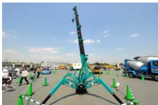
カニクレーン
