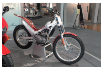
トライアル車として世界で初めてPGM-FIが搭載されたHonda RTL250F (2005年)がHonda Collection Hallに展示されました。
